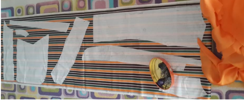
Resim: 5 Kumaş Yerleştirme Aşaması
