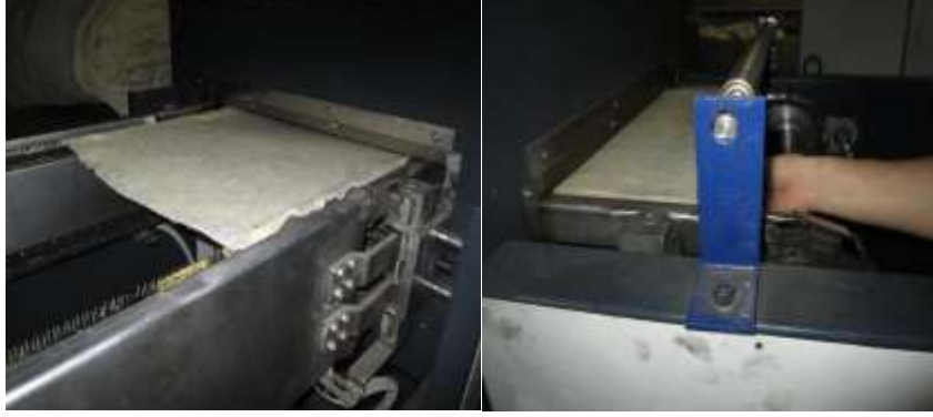
Resim 11 ve 12. Ramözde kurutma işlemi
